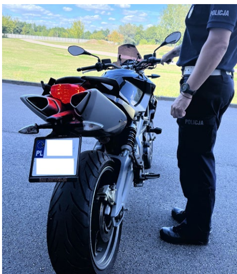
Fot. 16. Kontrola stanu oświetlenia motocykla z tyłu – sprawdzenie działania światła hamowania poprzez naciśnięcie dźwigni hamulca przedniego.
