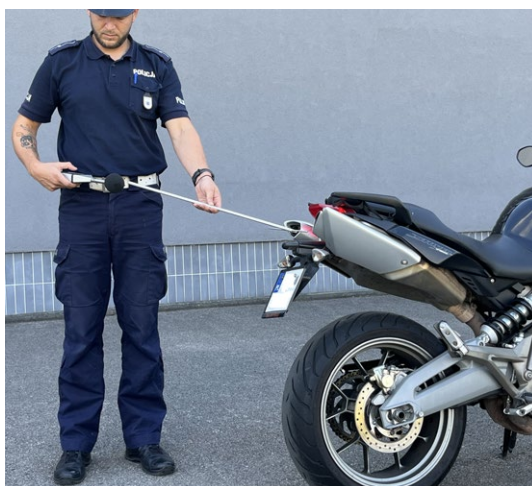
Fot. 21. Kontrola hałasu emitowanego przez pojazd oraz sygnału dźwiękowego.
