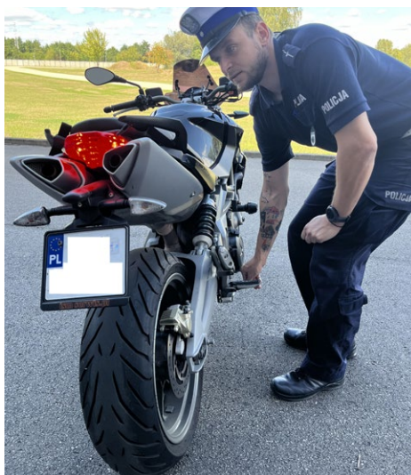
Fot. 17. Kontrola stanu oświetlenia motocykla z tyłu – sprawdzenie działania światła hamowania poprzez naciśnięcie dźwigni hamulca nożnego
