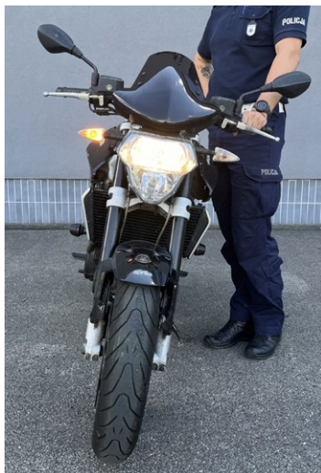
Fot. 13. Kontrola stanu oświetlenia motocykla z przodu – sprawdzenie działania światła mijania i kierunkowskazów.
