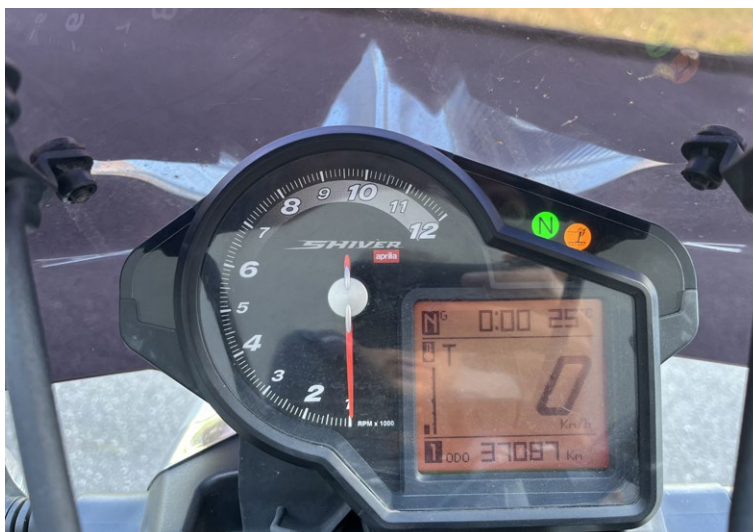
Fot. 6. Kontrola stanu drogomierza i samodiagnostyki układów motocykla.
