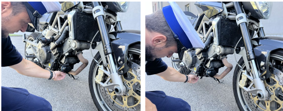
Fot. 22–23. Kontrola wycieków płynów eksploatacyjnych.
