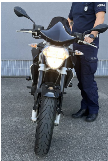
Fot. 14. Kontrola stanu oświetlenia motocykla z przodu – sprawdzenie działania światła drogowego.
