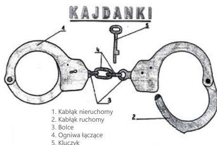
Rys. 1. Budowa kajdanki zakładanych na ręce. Autor: L. Dyduch.
