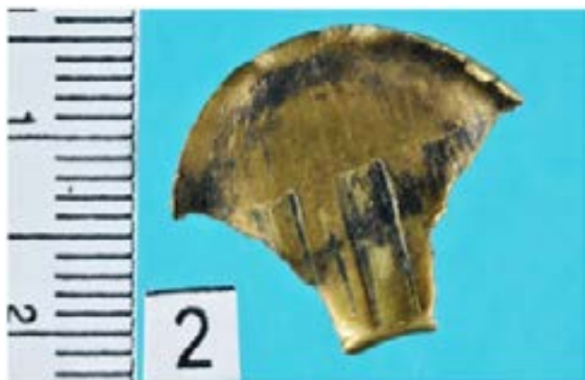
Fot. 22. Uszkodzenia na płaszczu pocisku zabezpieczone fotograficznie przy użyciu światła kąтового (światłocieni).
