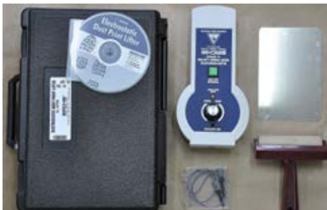
Fot. 21. Urządzenie MES do zabezpieczania śladów traseologicznych metodą elektrostatyczną.
