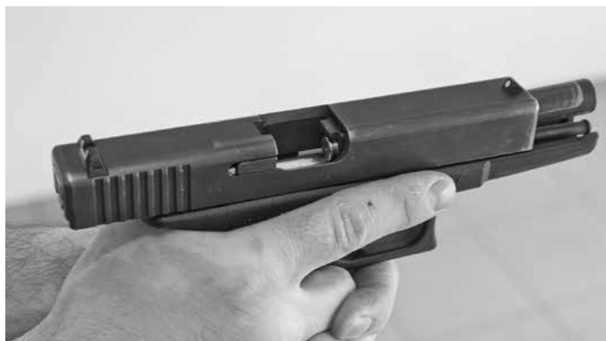
Zablokowanie pistoletu na skutek nieprawidłowego usunięcia niedomknięcia komory nabojoyej.
