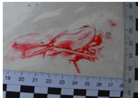
Substancja koloru czerwonego na zbiorniku paliwa
