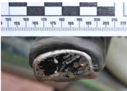
29. Usytuowanie uszkodzenia prawego podnóżka
