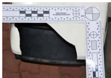
Ubytek części z tworzywa sztucznego nad błotnikiem koła tylnego
