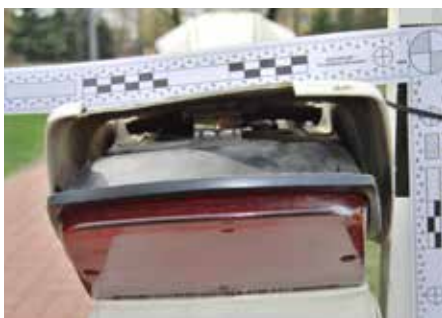
Wypięcie lampy tylnej z mocowania
