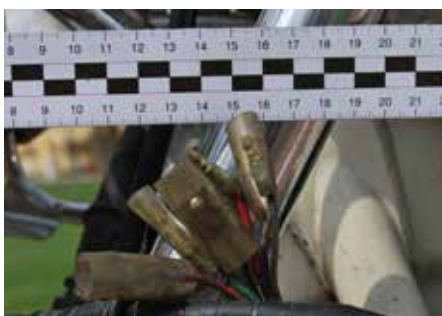
Uszkodzenie – rozpięta wiązka przewodów elektrycznych
