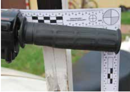
Uszkodzenie lewej manetki i brak dźwigni sprzęgła
