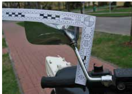
Otarcia na obudowie prawego lusterka
