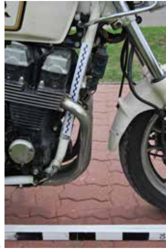
Usytuowanie odłamania prawego gmola
