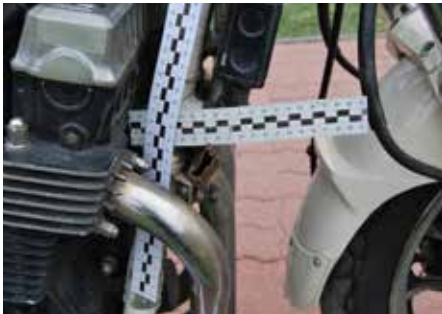
Miejsce odłamania prawego gmola – zastosowanie dwóch przymiarów skalowych
