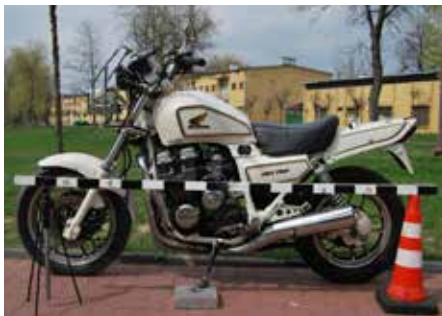
Ułożenie listwy pomiarowej (wyskalowanie co 10 cm)
