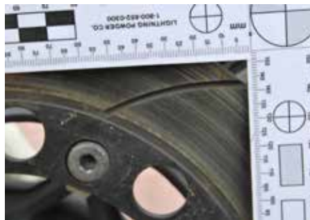
Fragment tarczy hamulcowej z widocznym rdzawym nalotem
