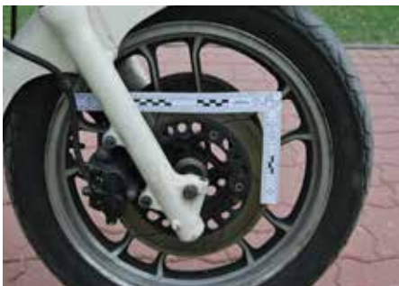
Tarcza hamulcowa koła przedniego z rdzawym nalotem
